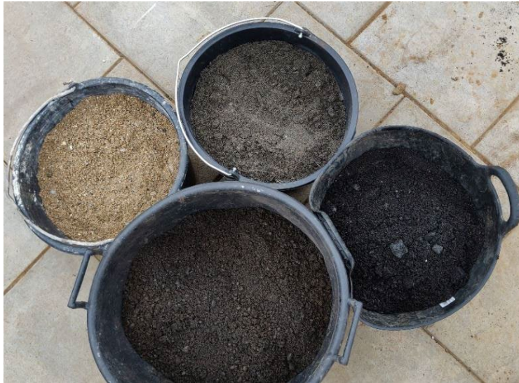
12. mynd: Mismunandi gerðir íblöndunarefna sem notuð voru í tilrauninni. Guli sandurinn er úr Sementsverksmiðjunni, grái er frá Ósi, stóra fatan er úr Mávahlíð og minni fatan er frá Botni.
