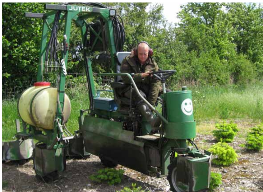
Mynd 6. „Portaltraktorar“ eru sérhönnuð tæki sem notuð eru við akurræktun jólatrjáa í Danmörku. Tvær mismunandi tegundir af slíkum vélum frá fyrirtækinu JUTEK, sem báðar eru að úða plöntuvarnarefnum í reiti með norðmannspín, eru sýndar hér. Ljósmynd Else Möller.
