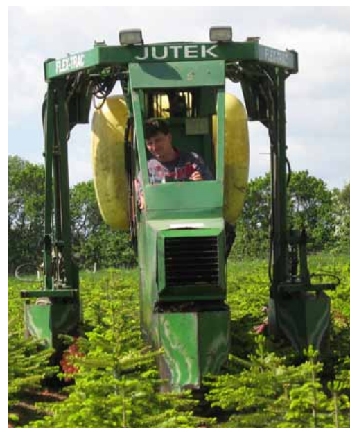
Mynd 6. „Portaltraktorar“ eru sérhönnuð tæki sem notuð eru við akurræktun jólatrjáa í Danmörku. Tvær mismunandi tegundir af slíkum vélum frá fyrirtækinu JUTEK, sem báðar eru að úða plöntuvarnarefnum í reiti með norðmannspín, eru sýndar hér. Ljósmynd Else Möller.
