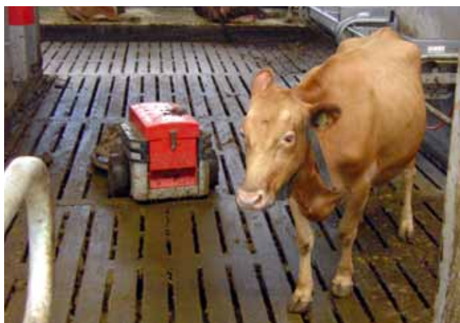
6. mynd. Mykjúpjarkur að störfum. Figure 7. Scraping robot at work.
