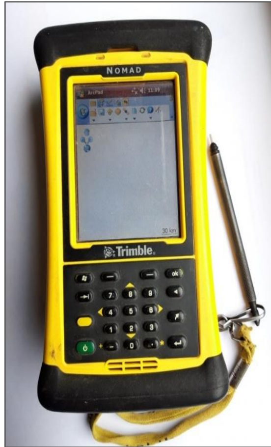
Mynd 6. Fyrsta árið var notuð Panasonic tölvu til að skrá athugunarbreytur á vettvangi en eftir það voru tekin í notkun Nomad Trimble lófátölvur (A Panasonic Toughbook was used to record field observation variables in the first year of the project. Trimble Nomad devices were used later on).
