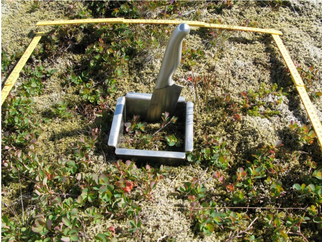
Mynd 12. Búnaður til töku svarðsýna (Sampling tools for sward samples).
