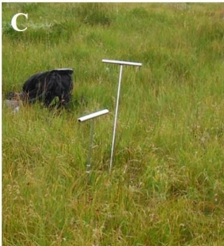
Mynd 7. Útbúnaður til mælinga og sýnatöku: A) Jarðvegsbor 20 mm í þvermál; B) 10*10 cm stálrammi til afmörkunar á svarðsýni; C) 1 m teinn með grópum með 10 cm millibili, til mælinga á jarðvegsdýpt; D) 2 tommustokkar sem notaðir voru til að afmarka 50*50 cm reit til gróðurflokkagreininga. (Field equipments: A) Soil sampler, 20 mm in diameter; B) 10*10 cm steel frame for sward sample; C) T-style, tubular sampler used for measuring soil depth, marking at 10-cm interval; D) 2-meter sticks used for delineate 50*50 cm plots, used for estimation of vegetation classes).
